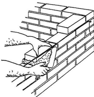
*Figura 8 - Retirada do excesso de argamassa*
