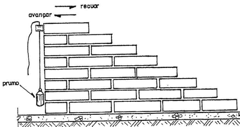
Figura 5 - Detalhe do prumo das alvenarias.
