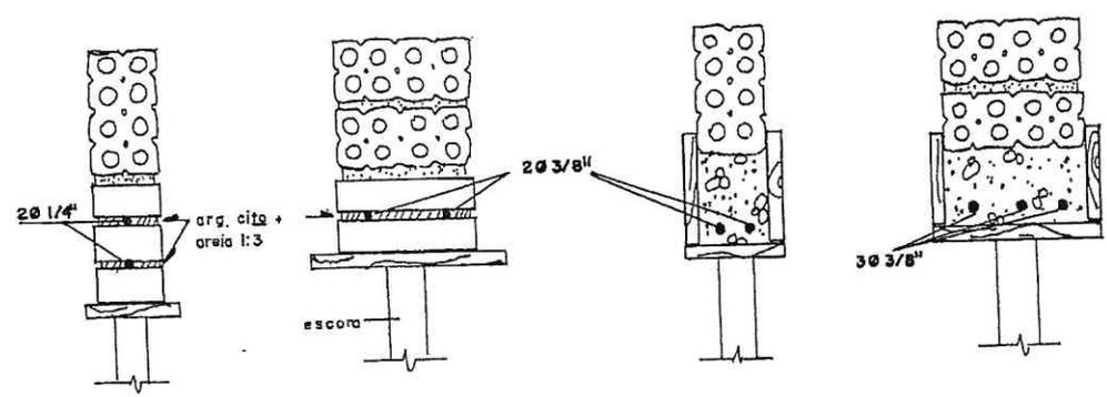
Figura 3 - Vergas em alvenaria de tijolo furado para vãos até 1,00m e entre 1,00m e 2,00m
