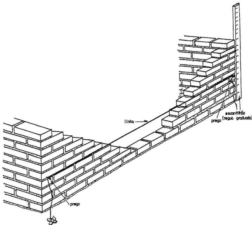
Figura 4 - Detalhe do nivelamento da elevação da alvenaria.
